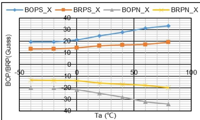
X 轴磁参数 vs. T<sub>a</sub>
