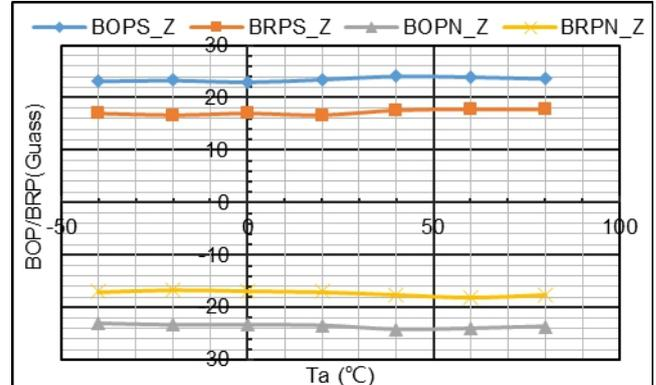
Z 轴磁参数 vs. T<sub>a</sub>
