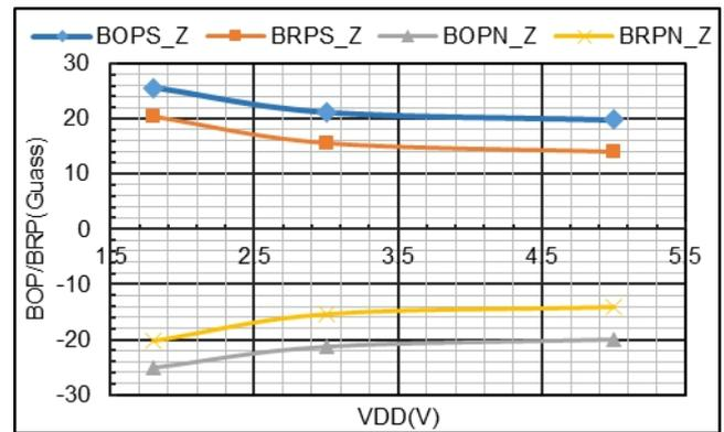
Z 轴磁参数 vs. V<sub>DD</sub>
