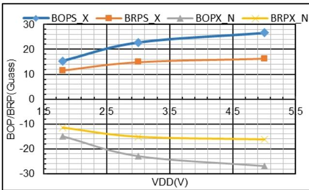
X 轴磁参数 vs. V<sub>DD</sub>
