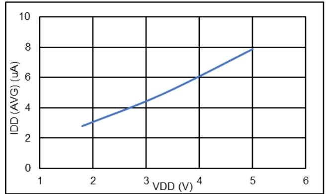
I<sub>DD(AVG)</sub> vs. V<sub>DD</sub>
